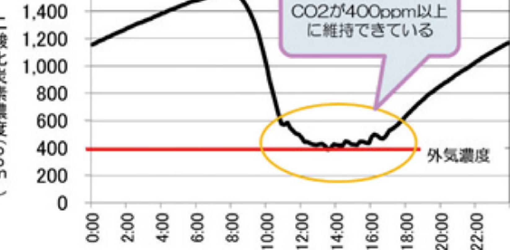
過去に取り組まれた、日の出前に1000 ppm程度の高濃度に施用する方法は、換気とともに二酸化炭素がハウス外に漏れてしまうこと、晴天日では数時間で消費されてしまい、日中に二酸化炭素が不足していたため、効果が不安定でした。現在すすめているのは、日の出から日の入りまでの日中に、二酸化炭素濃度を外気と同じ400 ppmに維持する方法(日中低濃度施用)です(図2)。この方法は、なすが光合成を盛んに行う時間帯に、ハウス内に不足する分の二酸化炭素を外気と同じ濃度で供給するため、無駄が少なく、効率的に施用することができます。
