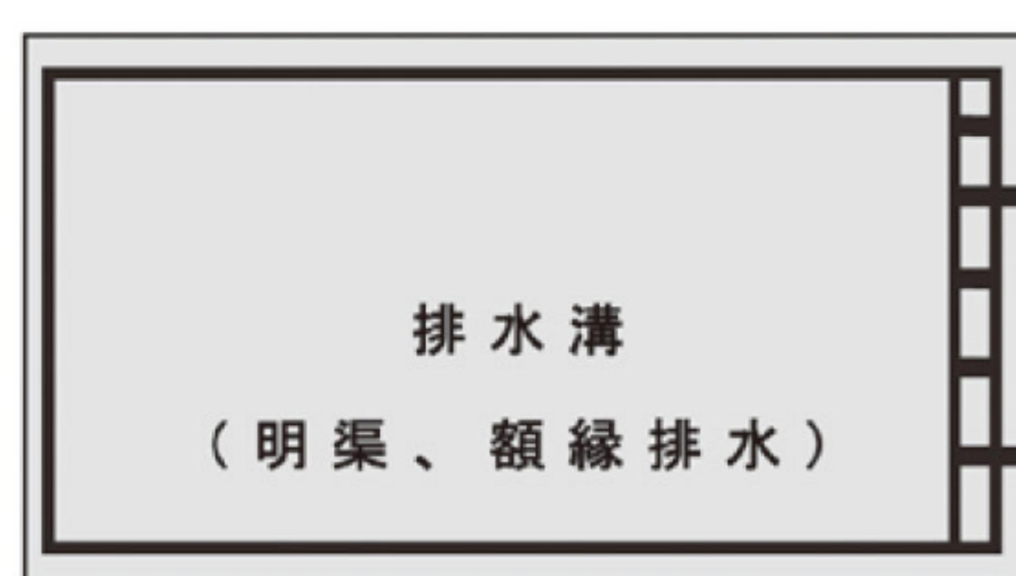
図2 明渠額縁排水の配置図
